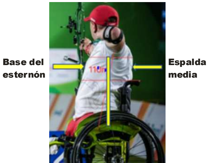
Imagen 19: Medición del soporte lateral de la silla de ruedas
