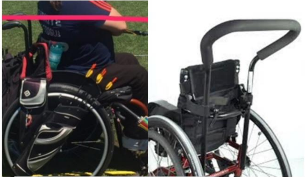
Imagen 21: Asideros de empuje no unidos al respaldo de la silla de ruedas)
