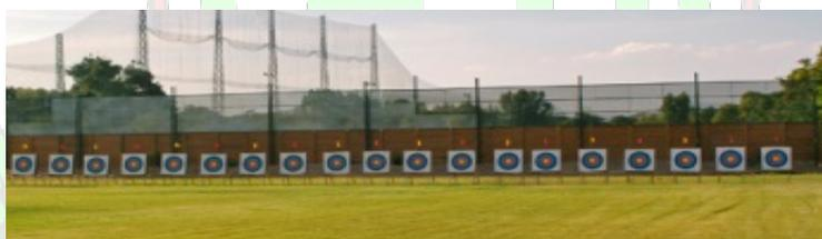
Las defensas de seguridad pueden ser instaladas en los laterales y tras la línea de dianas, en ambos casos servirán para reducir la distancia de seguridad tras la línea de dianas y los ángulos de seguridad de los laterales del campo de tiro.
